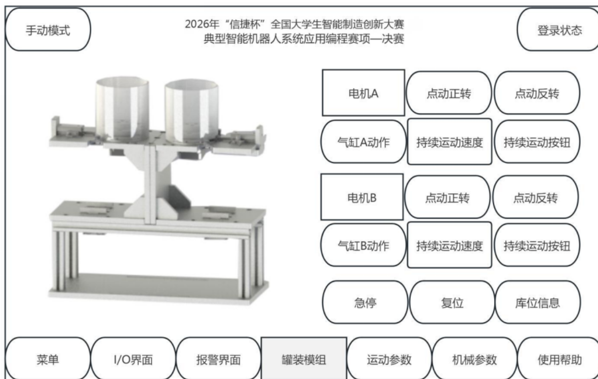
图 2.5 罐装模组 HMI 界面示例
