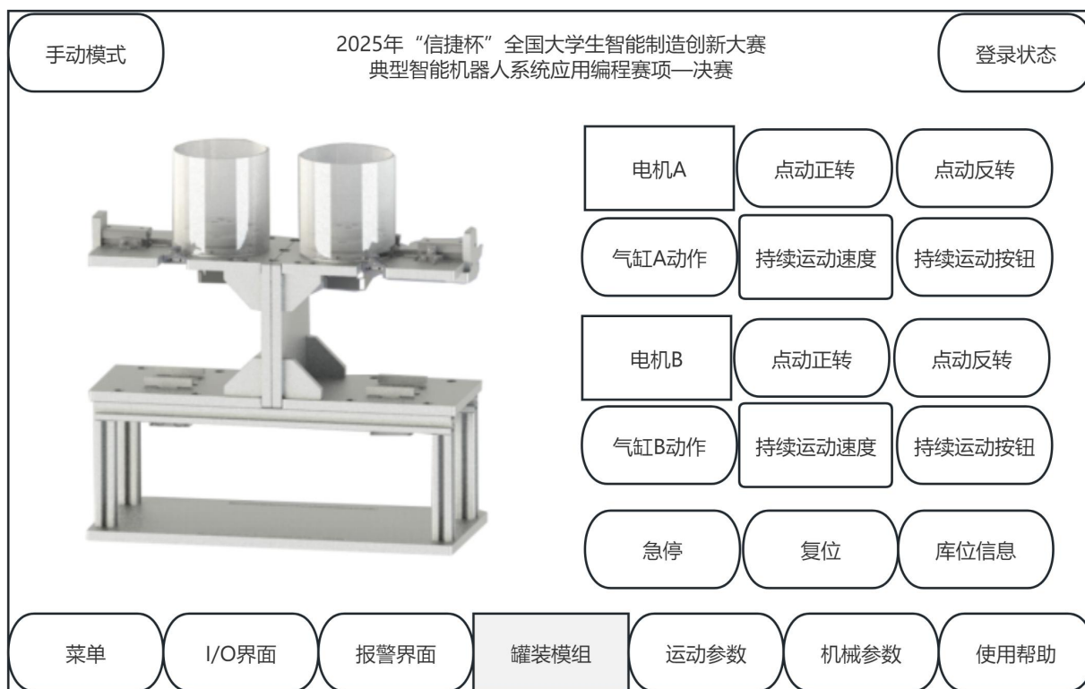
图 2.5 罐装模组 HMI 界面示例
