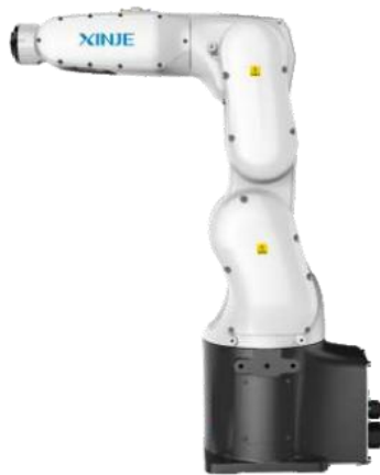
图 1.3 六轴机器人本体实物图
